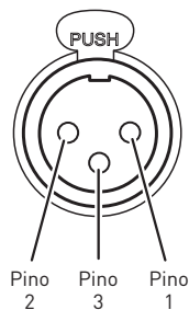
Conector de Entrada Equilibrado (fêmea XLR)
